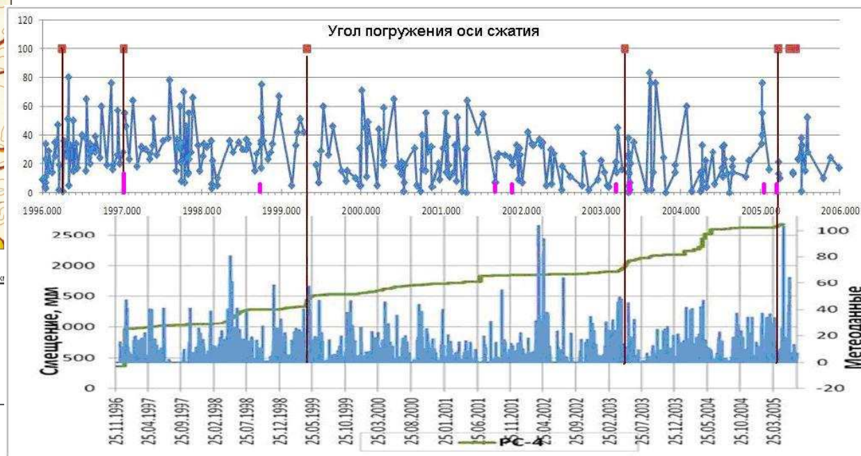
Сопоставление смещений на пункте РС-4 с углом погружения оси сжатия и метеоданными.
